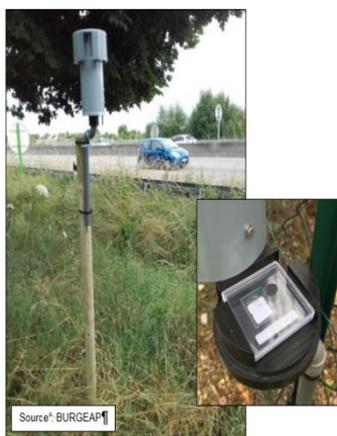
**Photographie du dispositif de prélèvement des poussières PM10**
